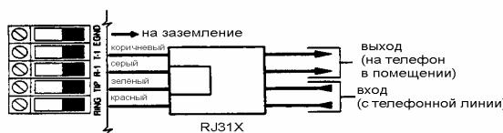
Для того, чтобы система правильно работала, между контрольной панелью и самой телефонной линией не должно быть никакого оборудования. Не подключайте передающее устройство к той линии, по которой планируете передавать факсы. Такие линии часто имеют голосовые фильтры, и связь разрывается, как только будет обнаружено что-то кроме факс аппарата, что приведёт к неполной передаче данных.
